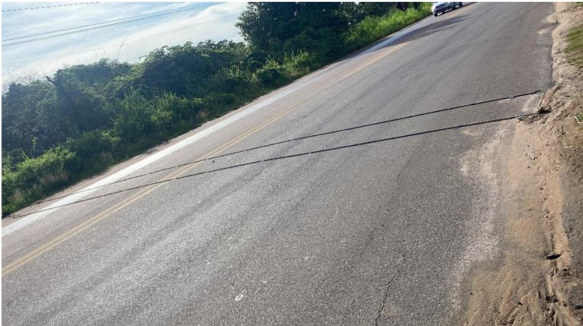
Figura 10: Equipamento MetroCount instalado em um dos pontos de coleta em Boa Vista.
